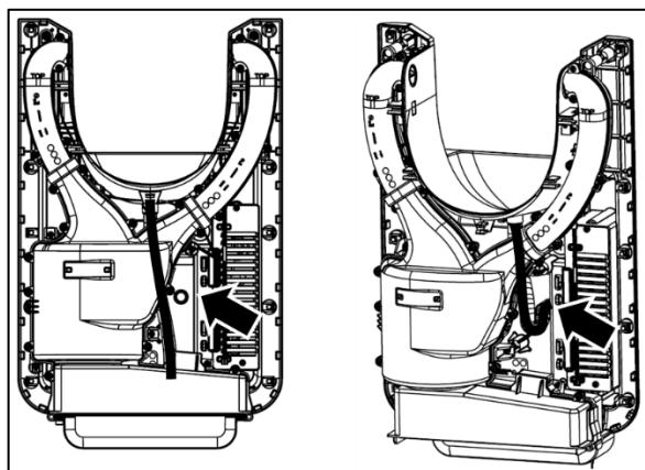
Montar a mangueira fornecida com a máquina no dreno na parte de trás da máquina.
