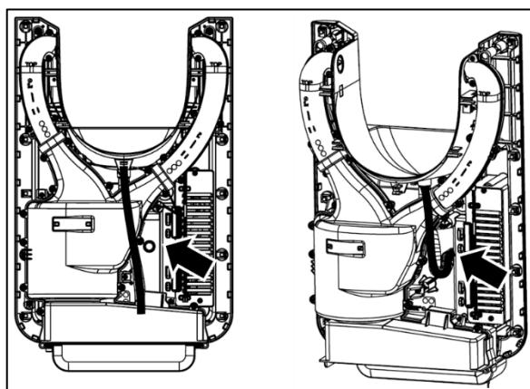
Fixez le tuyau fourni avec l'appareil à l'orifice d'évacuation situé à l'arrière de l'appareil. Fixez l'appareil au mur en tenant compte du fait que le tuyau monté sur l'appareil doit pénétrer dans l'évacuation murale.
