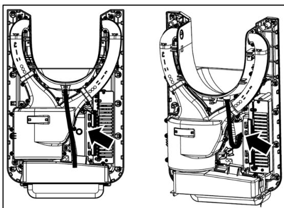
Inserire il tubo flessibile, in dotazione con la macchina, nello scarico sul retro della macchina stessa. Montare la macchina sulla parete tenendo conto che il tubo flessibile montato sulla macchina deve entrare nello scarico della parete.
