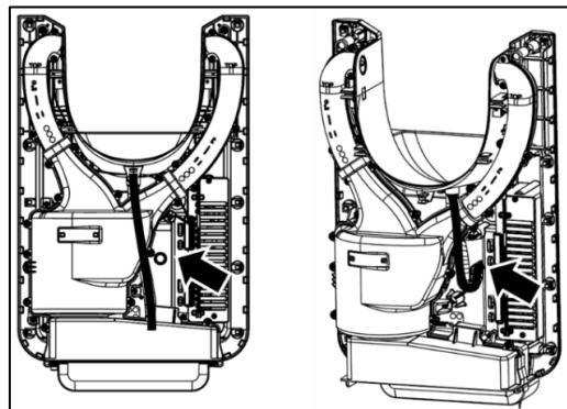
Schließen Sie den mit der Maschine gelieferten Schlauch an den Abfluss an der Rückseite der Maschine an. Montieren Sie die Maschine an der Wand und berücksichtigen Sie dabei, dass der an der Maschine montierte Schlauch in den Wandablauf münden muss.
