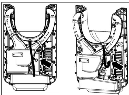
Подсоедините шланг, входящий в комплект поставки машины, к сливному отверстию в задней части машины. Установите машину на стене так, чтобы подсоединененный к ней шланг входил в настенный слив.
