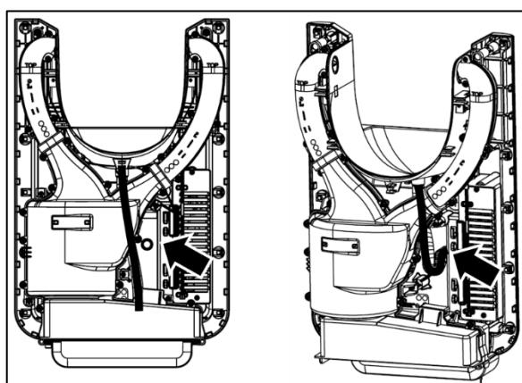
Montar la manguera que se suministra con la máquina en el desagüe de la parte posterior de la máquina. Montar la máquina en la pared teniendo en cuenta que la manguera montada en la máquina debe entrar dentro del desagüe de la pared.
